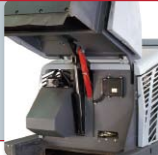
Un sistema di blocco del cassone rifiuti può essere attivato direttamente dalla postazione dell'operatore
