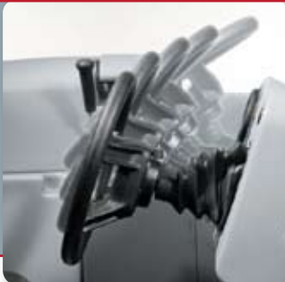
Sedile e volante regolabili permettono all'operatore un'ottima visione dell'area di lavoro per garantire maggiore sicurezza e minore fatica
